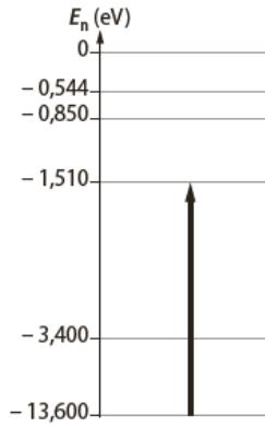
$c \cdot \lambda = \frac{hc}{\Delta E}$  avec  $\Delta E = 12,1 \times 1,602 \times 10^{-19} \text{ J} : \lambda = 103 \text{ nm.}$
